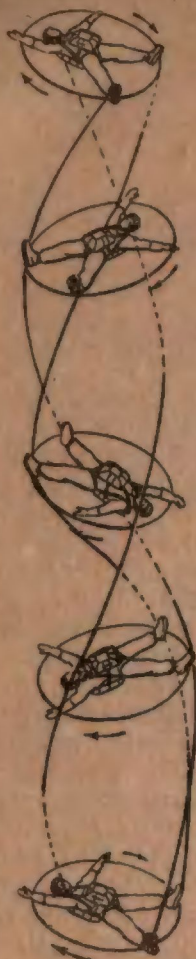
Рис. 28. Схематическое изображение плоского штопора
