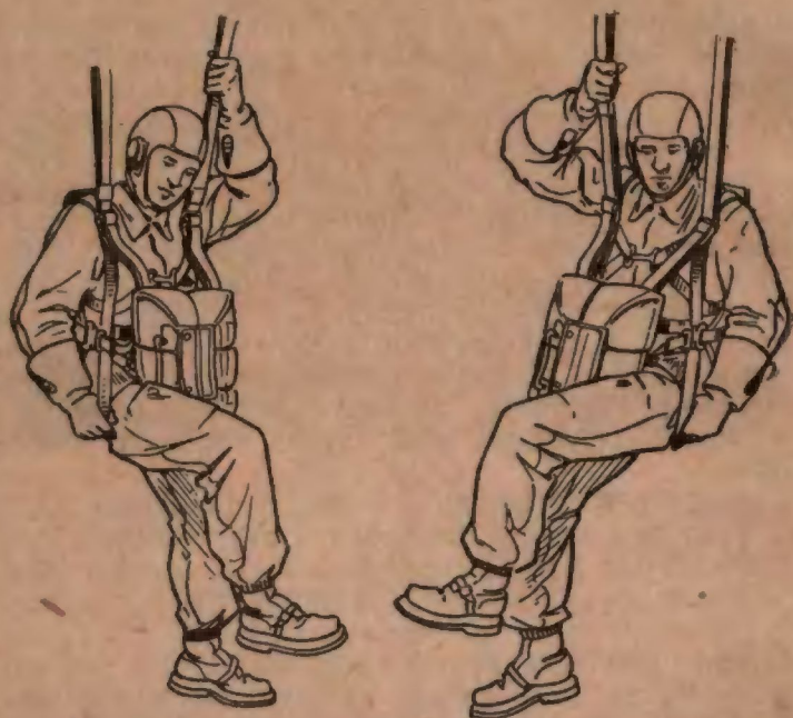
Рис. 82. Заправка правой и левой строп круговой лямки подвесной системы
