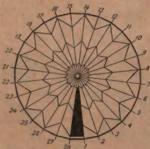
Рис. 41. Купол парашюта Т-2. Заштрихованный клин — щель в куполе
