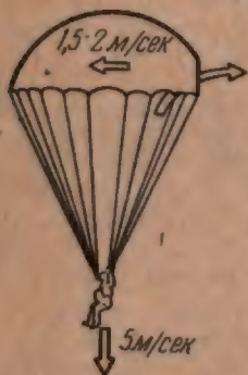
Рис. 144. Схема движения парашюта с куполом квадратной формы с килем
