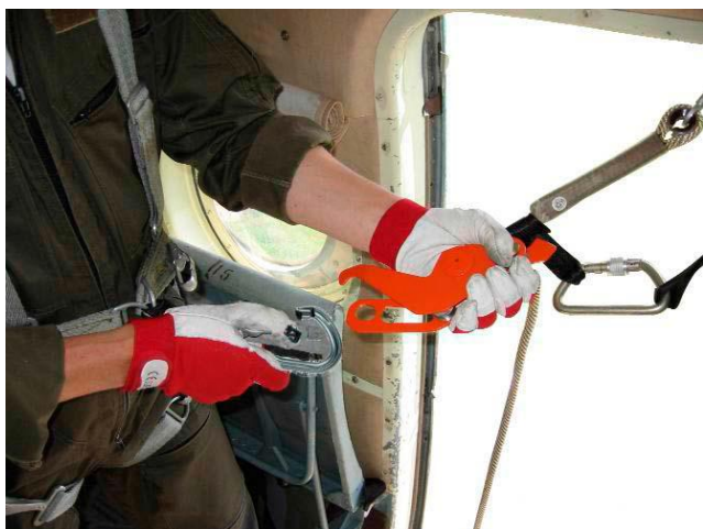
Рисунок 25 – Подсоединение карабина с автоматической муфтой к тормозному блоку
