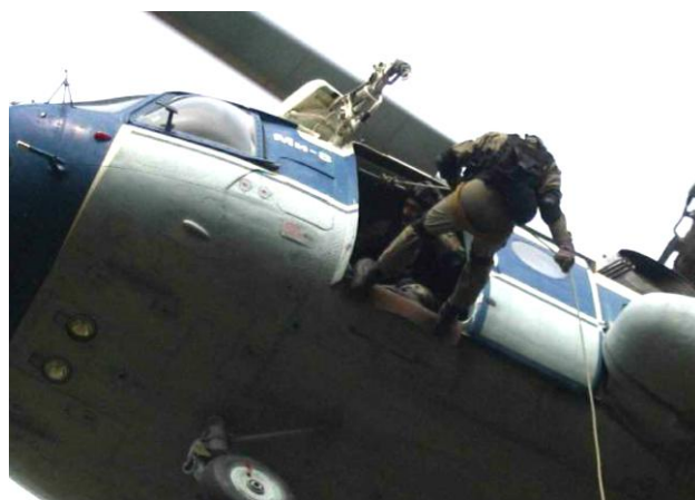
Рисунок 26 – Положение узлов КС-К перед началом спуска десантника по шнуру
