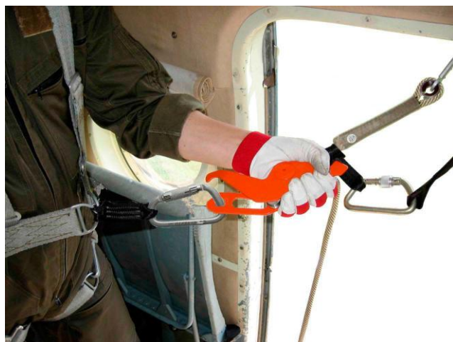
Рисунок 25 – Подсоединение карабина с автоматической муфтой к тормозному блоку
