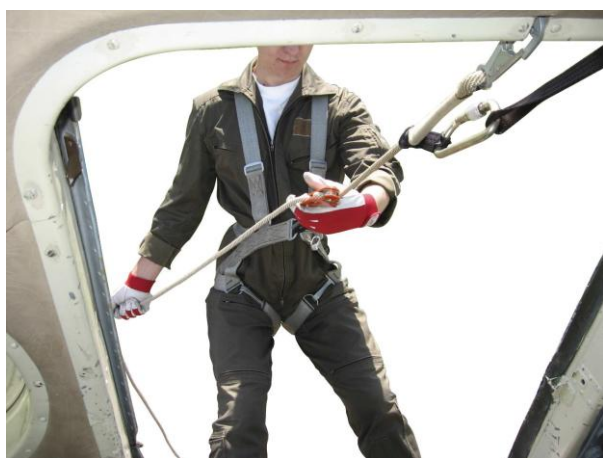
Рисунок 26 – Положение узлов КС-К перед началом спуска десантника по шнуру
